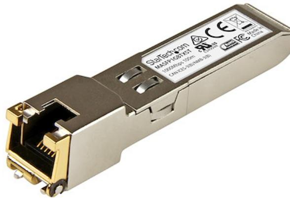
El modelo MASFP1GBSXST es un módulo transceptor por cobre compatible con el modelo MA-SFP-1GB-SX de Cisco Meraki, diseñado, programado y probado para su funcionamiento con enrutadores y conmutadores de la marca Cisco Meraki™. Ofrece conectividad 1GbE (1000Mbps) confiable a través de cable de cobre, para redes compatibles con 10BASE-T, 1000BASE-T y 100BASE-TX, con una distancia máxima de hasta 100m.
