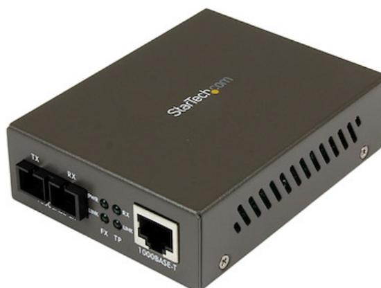
Le convertisseur Gigabit Ethernet fibre optique SC multimode 1 000 Mb/s 550 m MCMGBSC055EU convertit de façon transparente vers/depuis des signaux Ethernet 1000Base-T et optiques 1000Base-SX, offrant une liaison Ethernet-fibre optique/cuivre-fibre optique économique pour l'extension d'une connexion réseau Ethernet sur une infrastructure en fibre optique multimode.
