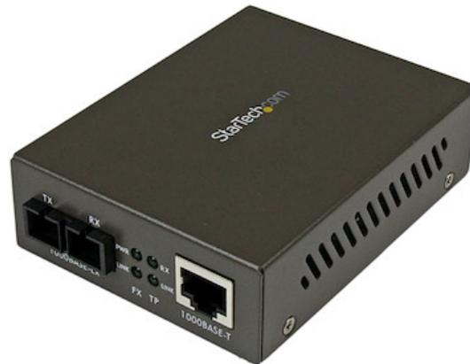
El Convertidor de Medios Ethernet, MCMGBSC15EU permite convertir señales Ethernet 1000Base-T en señales ópticas 1000Base-LH, y viceversa, brindando un enlace Ethernet-fibra/cobre-fibra eficaz y económico ideal para extender una conexión de red Ethernet a través de un backbone de fibra de Modo Único.
