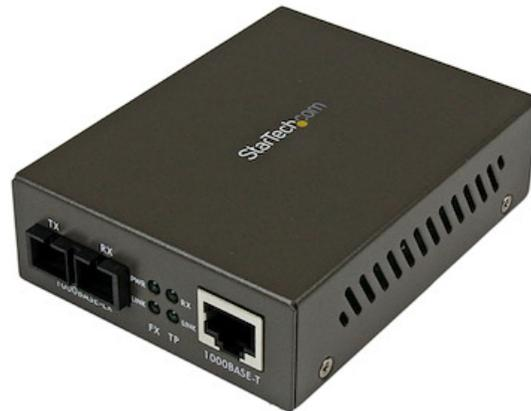
Le convertisseur Ethernet MCMGBSC15EU convertit de façon transparente vers/depuis des signaux Ethernet 1000Base-T et optiques 1000Base-LH, offrant une liaison Ethernet-fibre optique/cuivre-fibre optique économique idéale pour l'extension d'une connexion réseau Ethernet sur une infrastructure en fibre optique monomode.
