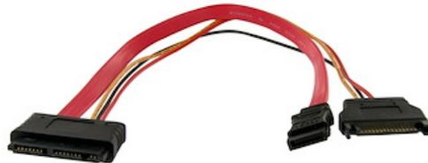
El cable adaptador Micro SATA a SATA de 12 pulgadas de StarTech.com, MCSATAF12S ofrece un conector de datos hembra SATA estándar y un conector de alimentación macho SATA en un extremo, y un conector hembra micro SATA en el otro, permitiendo conectar una Unidad de Estado Sólido (SSD) de 1,8 pulgadas a un ordenador tal como si fuera una unidad de disco duro SATA de factor de forma estándar.
