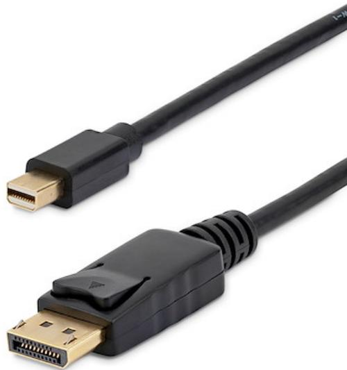
El cable adaptador Mini DisplayPort a DisplayPort (1,8 metros), modelo MDP2DPMM6, incluye un conector Mini DisplayPort (macho) en un extremo y un conector DisplayPort (macho) en el otro extremo, lo cual permite conectar cualquier computador portátil equipado con Mini DisplayPort (incluida la familia de productos Mac®) a un monitor, proyector o televisor HDTV que utilice una conexión DisplayPort estándar.
