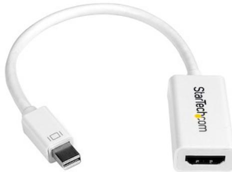
El adaptador Mini DisplayPort a HDMI, modelo MDP2HD4KSW, le permite conectar un computador equipado con mDP, como el MacBook® Pro y MacBook® Air, a una pantalla HDMI. Este adaptador es compatible con Mini DisplayPort 1.2 y HDMI 4K a 30Hz; por tanto, admite resoluciones de video de hasta Ultra HD (4K), así como el correspondiente audio digital hasta calidad de sonido envolvente de 7,1 canales.
