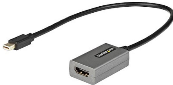
Este adaptador de Mini DisplayPort™ a HDMI® le permite conectar su ordenador mDP a un HDMI, televisión, proyector o monitor.
