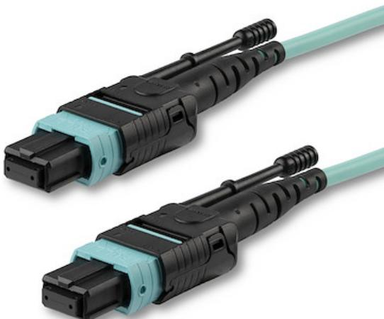
Este cable de fibra óptica MPO/MTP alberga 12 fibras y le permite establecer una interfaz entre diferentes dispositivos de red de distintas velocidades. Por ejemplo, puede establecer una conexión uno a uno entre dos conmutadores o servidores de 40Gbps. Como alternativa, puede conectar un conmutador de 40 Gbps y dividir los 40 Gbps en seis conexiones LC dúplex de 10 Gbps en un panel de conexiones o un casete de red, que luego se distribuyen hacia dispositivos individuales de 10 Gbps.
