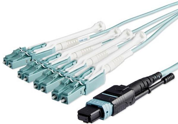
Mit diesem MPO/MTP auf 4x LC Breakout Kabel können Sie eine einzelne 40 Gbit/s Verbindung von einem 40GBase-SR4 QSFP+ Transceiver auf vier 10-Gbit/s LC SFP+ Transceiver verteilen.
