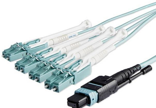
Este cable de conexión MPO / MTP a 4x LC le permite distribuir una sola conexión de 40 Gbps desde un transceptor 40GBase-SR4 QSFP + a cuatro transceptores LC SFP + de 10 Gbps. Las pestañas de empujar y tirar optimizan la accesibilidad y le permiten instalar o quitar los conectores con una mano sin utilizar herramientas adicionales. Además, el diseño delgado uniboot de los conectores LC ahorra espacio y mejora la gestión de cables.
