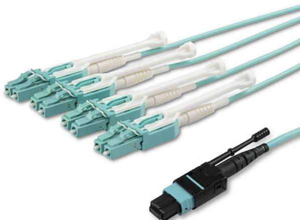
Ce câble répartiteur MPO/MTP vers quatre LC vous permet de répartir une connexion unique de 40 Gb/s provenant d'un transceiver QSFP+ 40GBase-SR4 vers quatre transceivers SFP+ LC de 10 Gb/s chacun.
