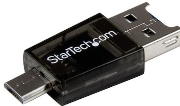
El adaptador Micro SD a USB/Micro USB, modelo MSDREADU2OTG, permite convertir una tarjeta Micro SD en solución externa USB de almacenamiento, que puede conectarse con cualquier PC equipado con USB o dispositivo equipado con OTG, como los smartphones y las tabletas Samsung Galaxy.
