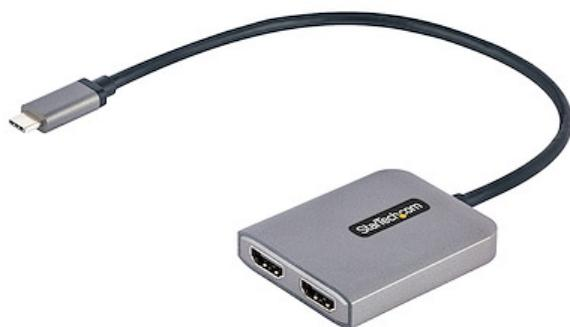
Questo HUB MST da USB-C a HDMI permette di collegare due Monitor HDMI, utilizzando un dispositivo host abilitato USB-C.
