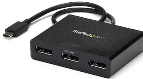
Este concentrador MST le permite conectar tres monitores DisplayPort a su computador portátil equipado con USB-C™. MST garantiza una configuración sencilla, ya que funciona a nivel nativo en cualquier dispositivo Windows®, compatible con el modo Alt (alternativo) de DisplayPort a través de USB Type-C™, como los modelos de computador portátil Dell Precision™ y Dell XPS™ y ASUS® ROG GL752.
