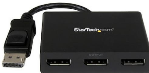
Mithilfe dieses MST-Hubs können Sie drei Monitore an einen DisplayPort™ (DP) 1.2-fähigen Windows®-Laptop oder Desktopcomputer anschließen.
