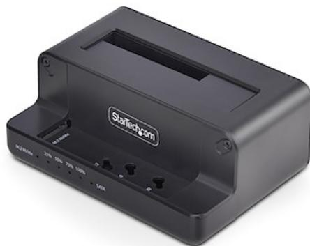
Realice una clonación bidireccional entre unidades M.2 NVMe y SSD/HDD SATA de 2.5/3.5" sin necesidad de un ordenador, utilizando este duplicador de unidades M.2 NVMe a SATA. La duplicación autónoma sector a sector es compatible con SATA III (6Gbps) y funciona con cualquier formato de fichero.
