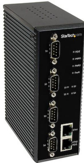
Mit dem PoE-betriebenen 4-Port-Industrie-Seriell-Geräteserver NETRS42348PD können Sie bis zu vier industrielle serielle RS232/422/485-Geräte über ein LAN- oder WAN-Netzwerk mit redundanten Stromeingängen und dualen 10/100-Mbit/s-Ethernet-Ports verwalten.
