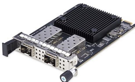
La tarjeta de interfaz de red OCP de 2 puertos a 10 Gbps con el controlador Intel X710-BM2 añade dos ranuras SFP+ abiertas a un servidor, aumentando las opciones de conectividad y el rendimiento de la red.
