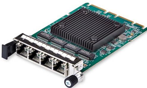
Questa scheda di interfaccia di rete (NIC) a 4 porte RJ45 1Gbps OCP 3.0 è dotata di un controller Ethernet Intel® i350-AM4 che migliora le prestazioni e l'integrità dei dati. La scheda Ethernet aderisce agli standard OCP 3.0 e garantisce un'ampia compatibilità, rendendola una soluzione ideale per una connettività di rete affidabile e solide capacità di trasferimento dati.
