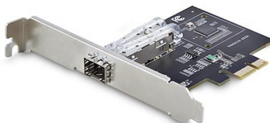
Agregue un módulo SFP de 1GbE a una ranura PCI Express (PCIe) 2.1 x1 (o superior) en una estación de trabajo de Administrador Informático o en la placa base de un servidor, utilizando este Controlador de Red SFP de 1 Puerto.
