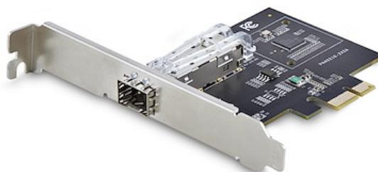
Ajoutez un module SFP 1GbE à un emplacement PCI Express (PCIe) 2.1 x1 (ou supérieur) sur une station de travail d'administrateur IT ou sur un fond de panier de serveur, en utilisant ce contrôleur réseau SFP 1 port.
