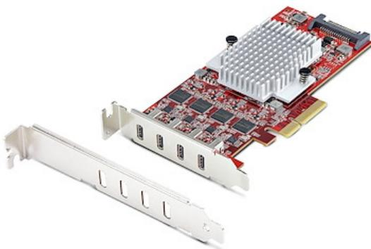
Amplíe la conectividad USB de un ordenador de sobremesa o servidor añadiendo cuatro puertos USB Type-C 10Gbps externos con esta tarjeta de expansión PCI Express 3.0 interna.
