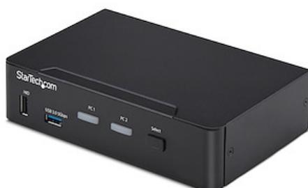
Este conmutador KVM DisplayPort permite a los usuarios cambiar entre dos ordenadores de sobremesa equipados con USB-A y DisplayPort. Permite compartir un monitor DisplayPort 4K a 60 Hz, un teclado, un ratón, dos dispositivos USB de 5 Gbps, un dispositivo de salida de audio estéreo y dos dispositivos USB 2.0 adicionales.
