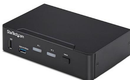
Questo switch KVM DisplayPort consente agli utenti di passare da un desktop dotato di USB-A e DisplayPort ad un altro. Permette di condividere un monitor DisplayPort 4K 60Hz, una tastiera, un mouse, due dispositivi USB 5Gbps, un'uscita audio stereo e due dispositivi USB 2.0 aggiuntivi.
