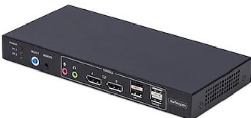
El conmutador KVM de matriz de vídeo le permite ver una pantalla desde cada ordenador conectado y conmutar el teclado, el ratón y el dispositivo de audio entre las pantallas seleccionadas mediante teclas de acceso rápido. También puede conmutar todos los periféricos conectados y ambos monitores como un KVM estándar.
