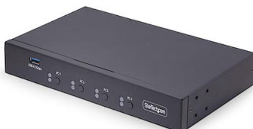
Questo commutatore per tastiera e mouse (KM) consente di commutare un'unica tastiera e un unico mouse tra più computer utilizzando la funzione di roaming del mouse, permettendo agli utenti di spostare il cursore senza problemi su più schermi (ad esempio, un monitor per computer).
