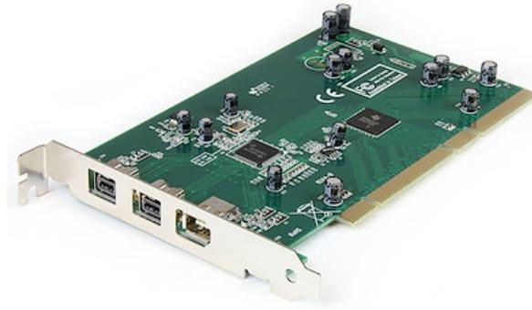
Cette carte FireWire 3 ports PCI1394B\_3 transforme un slot PCI en 2 ports FireWire 800 (IEEE 1394b) et 1 port FireWire 400 (IEEE 1394a), offrant ainsi une solution économique vous permettant de connecter des périphériques FireWire 800 et des FireWire 400 plus anciens sur votre ordinateur de bureau.
