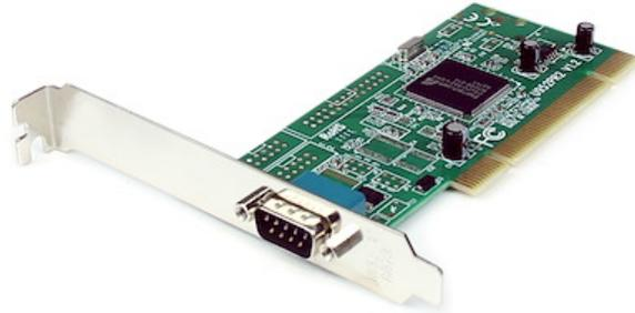
La carte adaptateur série 1 port PCI RS232 avec 16950 UART à tension double PCI1S950DV offre un canal/port UART 16950 à haute performance permettant de connecter tout périphérique récent ou traditionnel, avec des taux de transfert des données pouvant atteindre 460 Kb/s.
