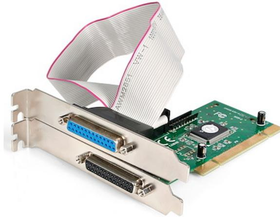
Die 2-Port-EPP/ECP-PCI-Parallel-Adapterkarte PCI2PECP kann in einen verfügbaren PCI-Steckplatz installiert werden, um dem PC zwei IEEE 1284-Ports hinzuzufügen mit Unterstützung für Datenübertragungsgeschwindigkeiten bis zu 1,5 Mbit/s (bis zu 3 Mal schneller als integrierte Parallel-Ports).
