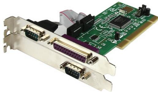
La carte combo série/parallèle PCI PCI2S1P transforme un logement PCI en deux ports série externes 16C550 et un port parallèle externe EPP/ECP, offrant ainsi une solution tout-en-un qui offre des connexions parallèles et série tout en n'occupant qu'un seul logement PCI.
