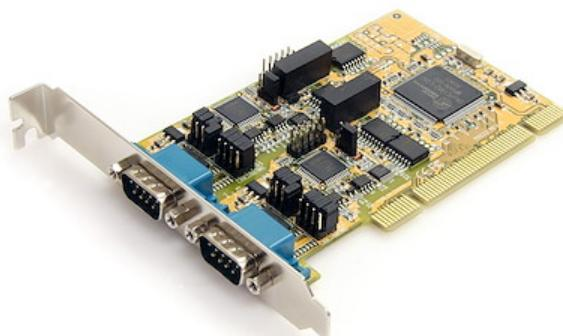
La tarjeta adaptadora serie PCI PCI2S232485I permite convertir una ranura para PCI o PCI-X en 2 puertos serie capaces de comunicarse en los modos operativos RS-232, RS-422 o RS-485, a tasas de transferencia de datos de hasta 921,6Kbps.
