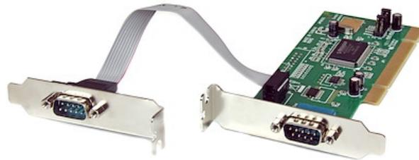
La Tarjeta de 2 puertos Serie 16550 se puede instalar en una ranura PCI para añadir dos puertos serie RS232 – una solución eficaz y económica que permite conectar cualquier dispositivo serial nuevo o antiguo pudiendo alcanzar velocidades de transferencia de hasta 115,2 Kbps. La tarjeta de puerto serie ofrece un soporte de perfil bajo para instalarla en gabinetes de perfil bajo/factor de forma pequeño.
