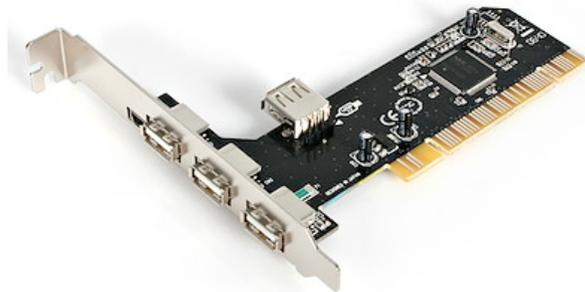
Questa scheda adattatore PCI USB 2.0 a 4 porte di StarTech.com consente di aggiungere tre porte USB 2.0 esterne e una porta USB 2.0 interna mediante la semplice installazione in un singolo slot PCI.
