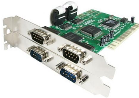
La carte série PCI PCI4S550N 4 ports transforme un logement PCI disponible en quatre ports série RS232, offrant ainsi une solution efficace pour connecter des périphériques série récents ou anciens, avec des vitesses de transfert de données d'au plus 115 Kbps.
