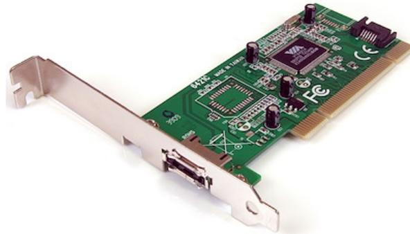
Cette carte contrôleur SATA basée sur PCI vous permet de transformer un logement PCI en un port interne SATA ou externe SATA (eSATA) Grâce à la prise en charge des disques durs SATA 150 et des vitesses de transfert de données d'au plus 1,5 Gbps, cette carte contrôleur offre une solution idéale en cas de besoin d'un port SATA supplémentaire ou si vous souhaitez externaliser votre stockage.
