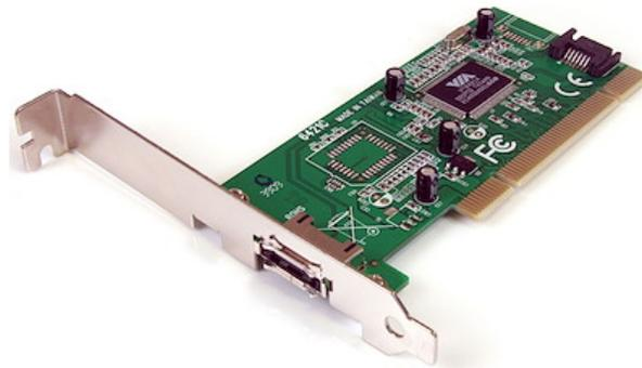
Questa scheda controller PCI SATA consente di trasformare lo slot PCI del computer in una connessione interna SATA e una connessione esterna (eSATA). Grazie al supporto di dischi rigidi SATA 150 e velocità di trasferimento dati fino a 1,5 Gbps questa scheda controller è la soluzione perfetta se si desidera una porta SATA aggiuntiva o sfruttare supporti di archiviazione esterna.
