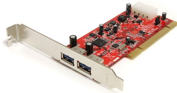
La scheda USB 3.0 SuperSpeed PCI a 2 porte PCIUSB3S2 permette il supporto dello standard USB 3.0, con velocità di trasferimento dei dati fino a 5 Gbps (10 volte superiori all'USB 2.0), per slot PCI di vecchia generazione. Grazie a USB 3.0 i dispositivi dotati di questa scheda potranno contare su velocità di trasferimento dei dati fino a 1,3 Gbps, raddoppiando le prestazioni rispetto alle schede e alle periferiche USB 2.0.
