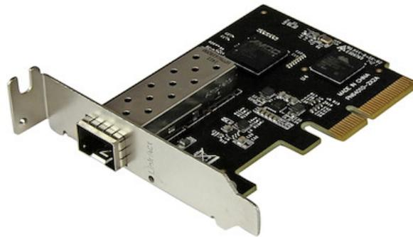
La scheda per rete in fibra 10 Gigabit PEX10000SFP rappresenta una soluzione conveniente che offre un accesso rapido e affidabile alla rete 10 Gbps a distanze maggiori rispetto alle reti in rame. Utilizzando il ricetrasmittitore SFP+ scelto è possibile collegare il server o la workstation basata su PCI Express direttamente alla rete in fibra ottica 10G.
