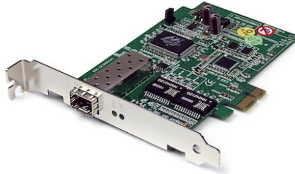
La carte réseau PCI Express Gigabit Ethernet à fibre optique avec SFP ouvert PEX1000SFP vous permet de connecter directement un ordinateur PCI Express à un réseau en fibre optique à l'aide du SFP Gigabit de votre choix.
