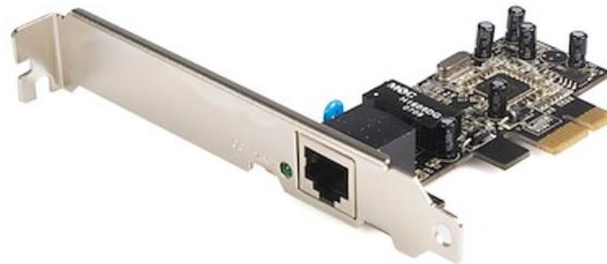
Cette carte Ethernet basée sur PCI Express 10/100 offre une manière simple de connecter un serveur ou une station de travail compatible PCIe à un réseau Ethernet ; elle est également richement dotée en fonctionnalités incluant la prise en charge du fonctionnement en mode duplex complet et semi-duplex ainsi que la gestion d'alimentation Wake On LAN (WOL).
