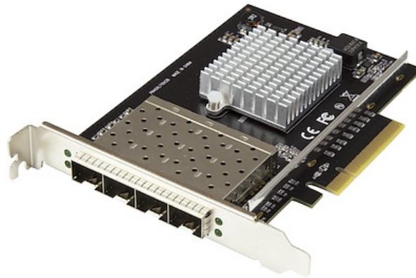
4ポートSFP+スロット搭載サーバーネットワークカード。オープンSFP+スロット4口をサーバー／ハイパワーワークステーションに増設し、信頼性に優れた高性能ネットワーク接続機能を提供します。ネットワークのニーズに合ったSFP+モジュールを使用し、大きなコストをかけずに10ギガビット光ファイバネットワークにアップグレードできるソリューションです。マルチモード、シングルモード光ファイバのどちらにでも対応できる柔軟性を提供します。
