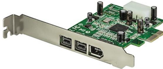
Cette carte adaptateur 3 ports PCI Express FireWire peut être installée dans un logement PCI Express pour ajouter deux ports IEEE1394b (FireWire 800 - 9 broches) et un port IEEE1394a (FireWire 400 - 6 broches), permettant une compatibilité avec de nombreux périphériques FireWire (par exemple, des caméscopes DV, des disques durs externes, des appareils-photos numériques, etc.).
