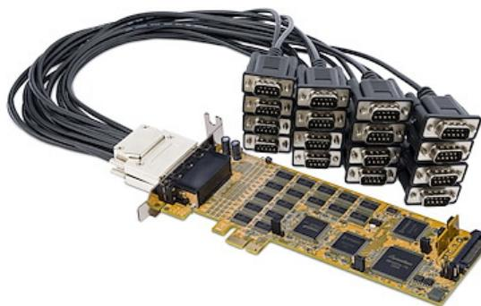
Esta tarjeta serie PCI Express añade 16 puertos RS232 de alta velocidad a su PC de sobremesa o servidor estándar o de bajo perfil. Esto le permite maximizar el número de puertos RS232 DB9 disponibles para conectar sus dispositivos y equipos basados en serie, a la vez que utiliza una única ranura PCI Express (PCIe). Es la solución perfecta para añadir los puertos serie que necesita, incluso si su PC de sobremesa o servidor sólo dispone de un número limitado de ranuras de expansión PCIe.
