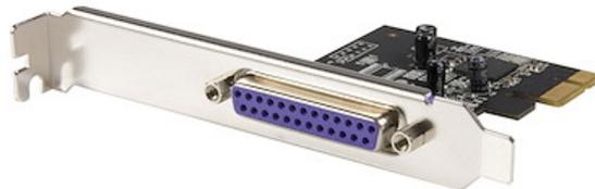
La carte adaptateur parallèle PEX1P PCIe peut être installée dans logement PCI Express (PCIe), vous permettant de connecter des périphériques parallèles EPP/ECP à tout système informatique. Reposant sur une conception de puce unique native(Oxford OXPCIe952), cet adaptateur permet d'optimiser les capacités de PCI Express, garantissant ainsi performance et fiabilité maximum.
