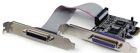
La scheda adattatore parallela PCI Express a 2 porte PEX2PECP2 - scheda parallela EPP/ECP/SPP/PS2 permette di aggiungere due porte parallele IEEE 1284 al PC con il supporto della comunicazione dati parallela con velocità fino a 1,5 Mbps.
