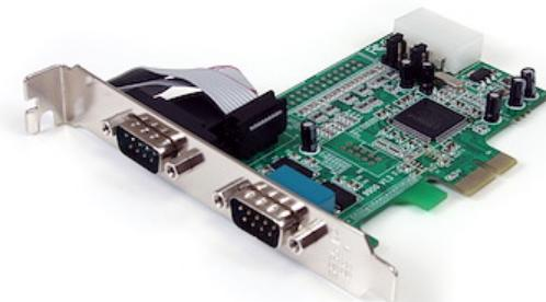
La scheda seriale PCI Express PEX2S553 consente di trasformare uno slot PCI Express in 2 porte seriali RS-232 (DB9). Basata su un design a chip singolo nativo (nessun chip ponte), questa scheda adattatore seriale a 2 porte permette di sfruttare le funzionalità complete offerte da PCI Express (PCIe) e di ridurre il carico applicato alla CPU fino al 48% rispetto alle schede seriali convenzionali.
