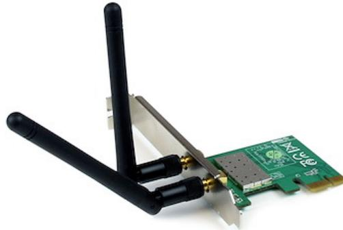
Die PEX300WN2X2 PCI Express drahtlose N Karte (PCIe x1) verleiht nahezu allen PCI-Express-fähigen Desktop/Workstation PCs drahtlose Hochgeschwindigkeits-Netzwerk-Konnektivität. Durch die Verwendung eines 2T2R-Design (2 Sender/2 Empfänger) über die 2,4 GHz-Frequenz bietet diese PCIe drahtlose Karte eine Bandbreite bis zu 300 Mbit/s über ein 802.11n Netzwerk bei gleichzeitiger Verbesserung des Signalempfangs und der Reichweite.
