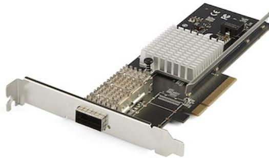
Questa scheda di rete per server QSFP+ consente di ottenere una connettività veloce a elevata larghezza di banda. L'adattatore di rete convergente aggiunge uno slot QSFP+ aperto al server o alla workstation. La scheda di interfaccia di rete da 40 Gb è dotata di controller Intel e assicura prestazioni affidabili. È l'ideale per server di database, server virtualizzati e data center flessibili con elevati volumi di dati che richiedono aggiornamenti dell'infrastruttura senza tempi di inattività.
