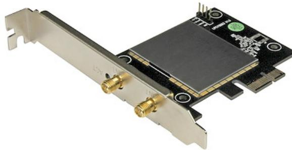
Rüsten Sie Ihren Desktop-PC oder Server mit leistungsfähiger 802.11ac-Drahtlosnetzwerkfunktion auf. Diese AC600-Netzwerkkarte passt ganz einfach in einen PCI Express-Erweiterungssteckplatz und bietet Dualband-Wireless-AC-Konnektivität mit Geschwindigkeiten von bis zu 433 Mbit/s.
